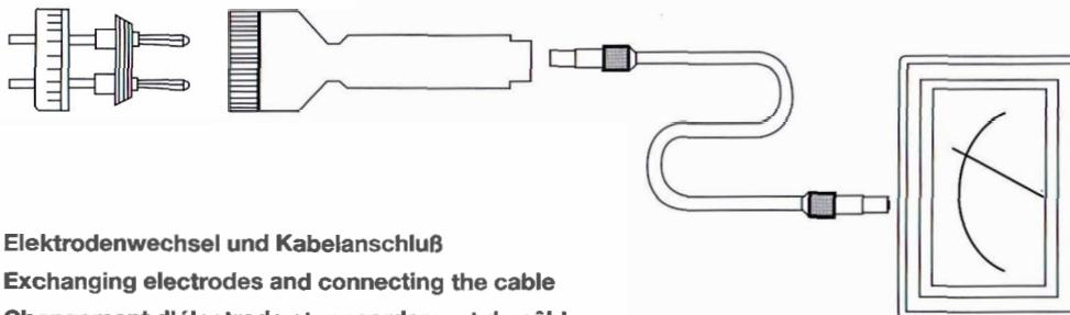
**Elektrodenwechsel und Kabelanschluß**
